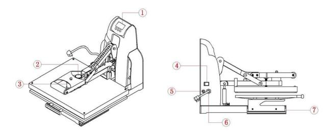
Digital DisplayPower switchBase Plate
